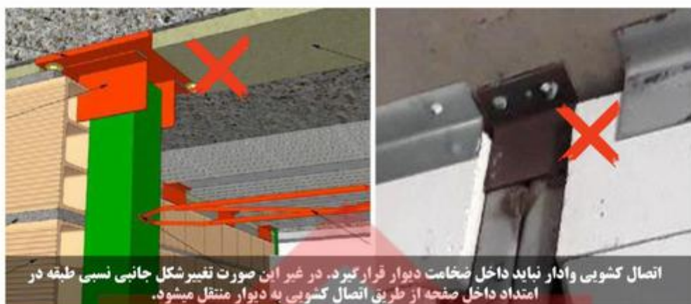
شکل پ-۷-۵ ایراد متداول مربوط به قرارگیری اتصال کشویی وادار در داخل ضخامت دیوار.
