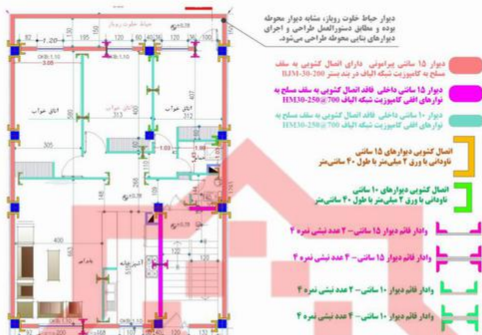
شکل پ-۶-۸ تیب‌بندی دیوارها، جانمایی و ادارهای قائم و اتصالات کشویی در طبقه همکف
