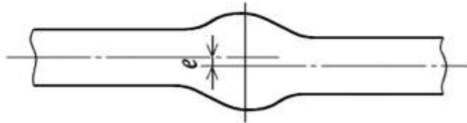
۱۲- قطر ناحیه برآمده جوش (D) نباید بیشتر از ۱/۴ برابر قطر آرماتور و کمتر از ۱/۱ برابر قطر آرماتور باشد. طول گرده جوش (l) حداقل ۱/۱ برابر قطر میلگرد باشد.
